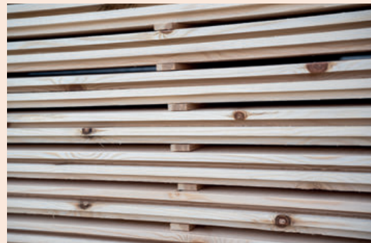
Korrekt ströläggning förbättrar kvaliteten på slutprodukten.
