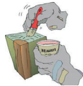
Inträngning av träskyddsmedel bestäms ofta med hjälp av reagenslösningar
