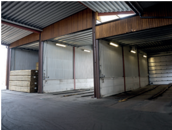
Kamrar för uppvärmning av virke för impregnering vintertid
