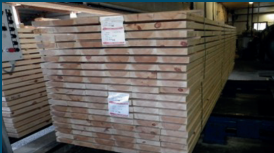
Uppskattning av splintvedsandelen är möjligt genom att betrakta ändträet på paketen.
